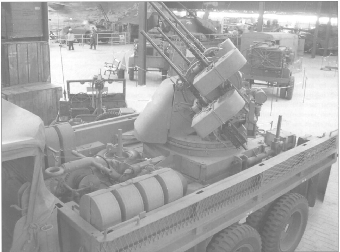
De GMC met de M55 in "Overloon". De lier is zichtbaar en weer anders dan in de GMC op de vorige pagina. De complete "mount" staat in een raam van hoekprofiel en is op de vier hoeken d.m.v. bouten vastgezet.
